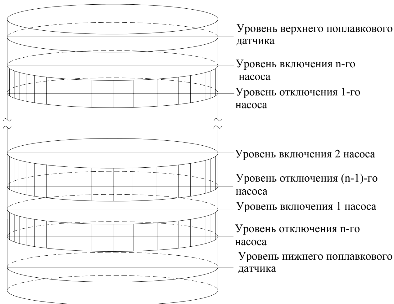
Рис. 5.1 Формирование команд пуск/стоп
