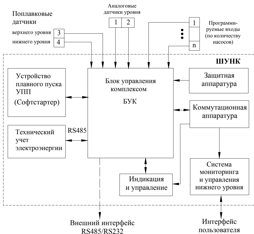
Рис.2.1. Структурная схема ШУНК серии «профи»
