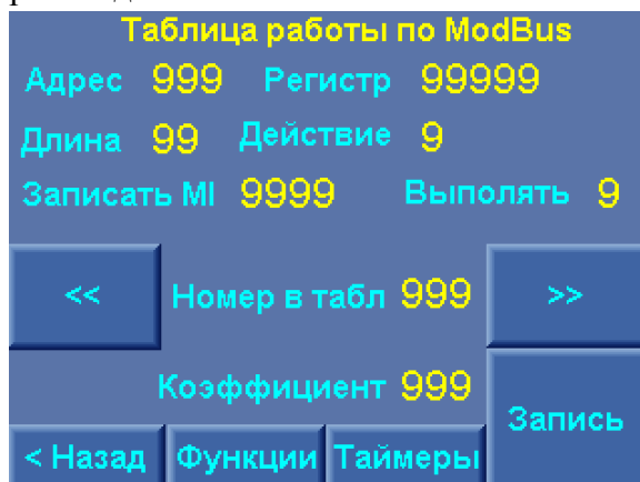
Рис. 5.1П. Меню настройки протокола ModBus
