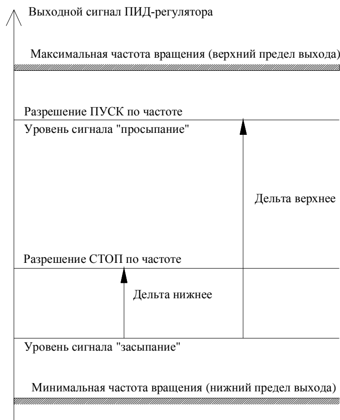
Рис. 4.2. Схема формирования команд управления по уровням сигнала ПИД-регулятора
