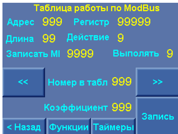
Рис. 6.1П. Меню настройки протокола ModBus
