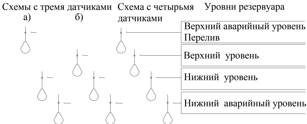
Рис. 6.1. Схемы подключения поплавковых (кондуктометрических) датчиков
