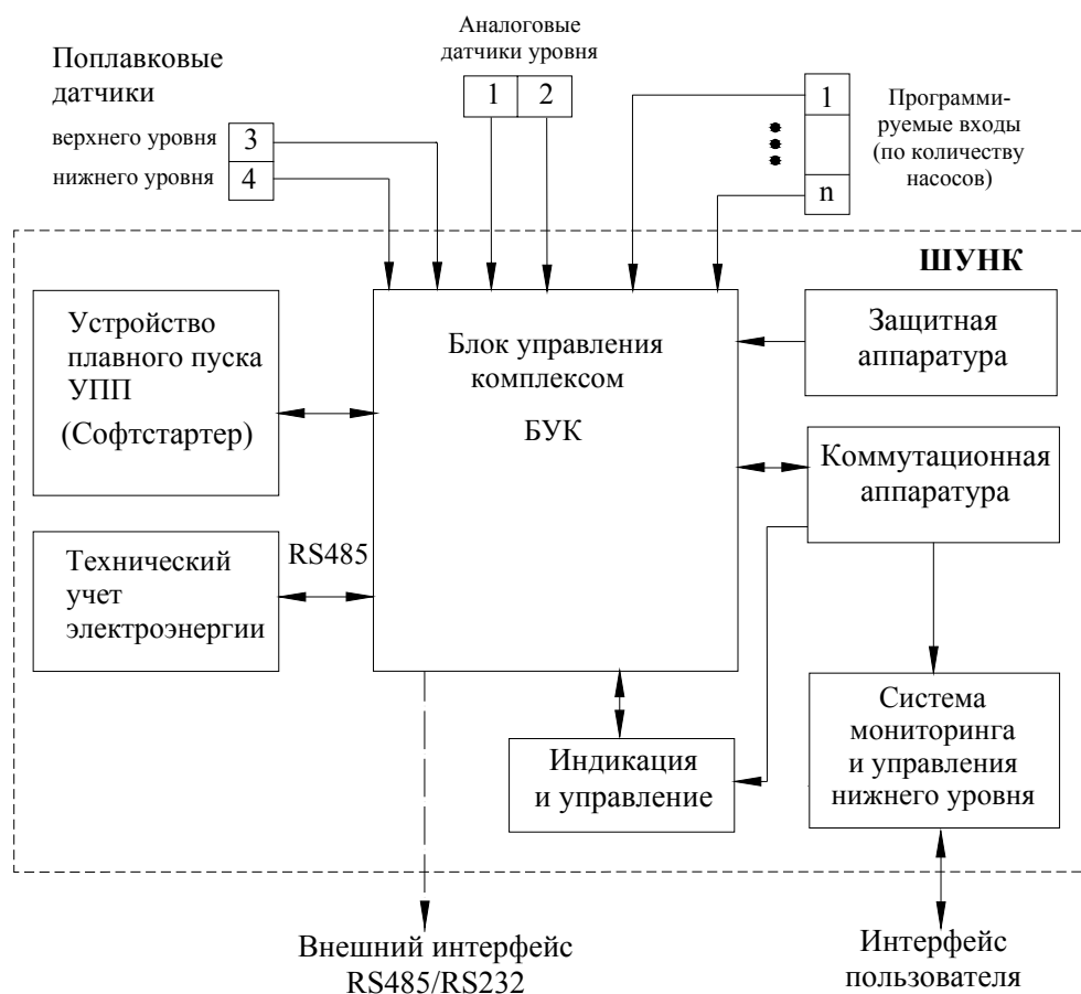
Рис.2.1. Структурная схема ШУНК серии «профи»
