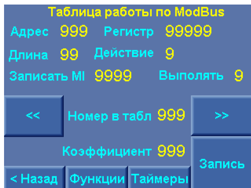
Рис. 6.1П. Меню настройки протокола ModBus
