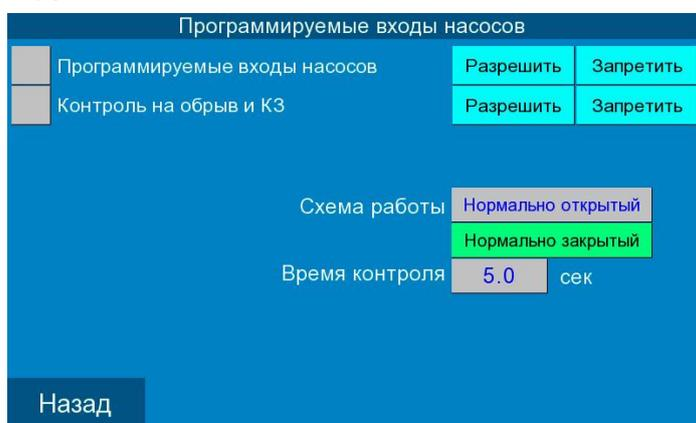
Рис. 15. Экран «Программируемые входы»
