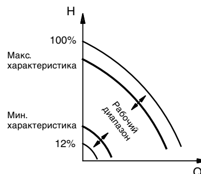
Рис. 21. Установка мин. и макс. характеристик в % от максимальной производительности
