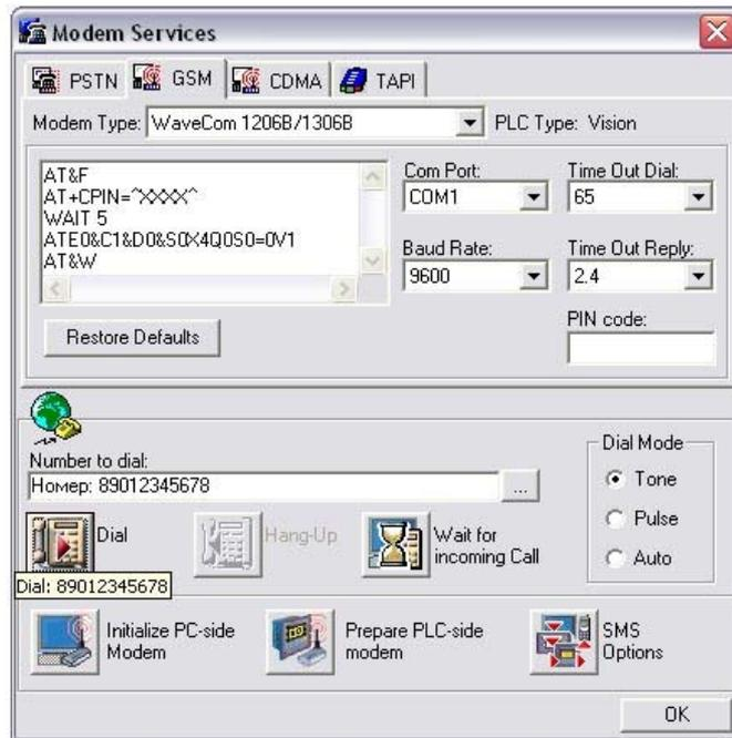
Рис. 7. Ввод номера модема и установка соединения
