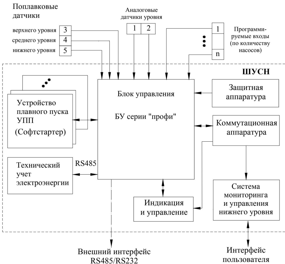
Рис.2.1. Структурная схема ШУСН серии «профи»
