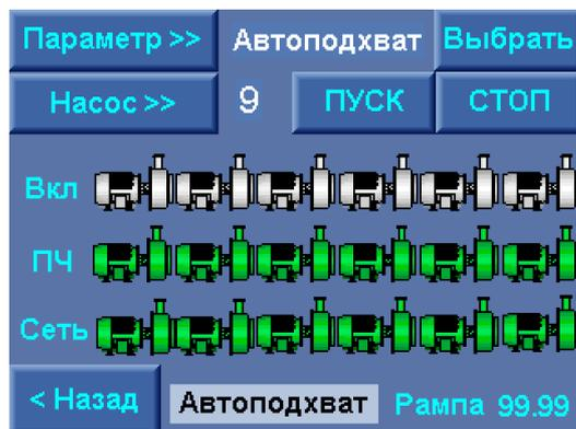
Рис. 8.3. Меню Рампового пуска насосов
