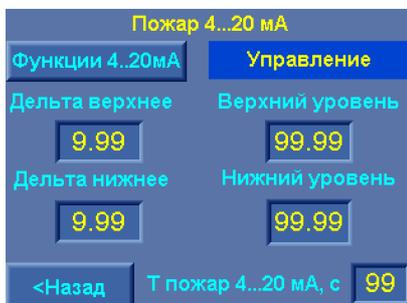
Рис. 9.29. Меню функций преобразователей давления в режиме ПОЖАР
