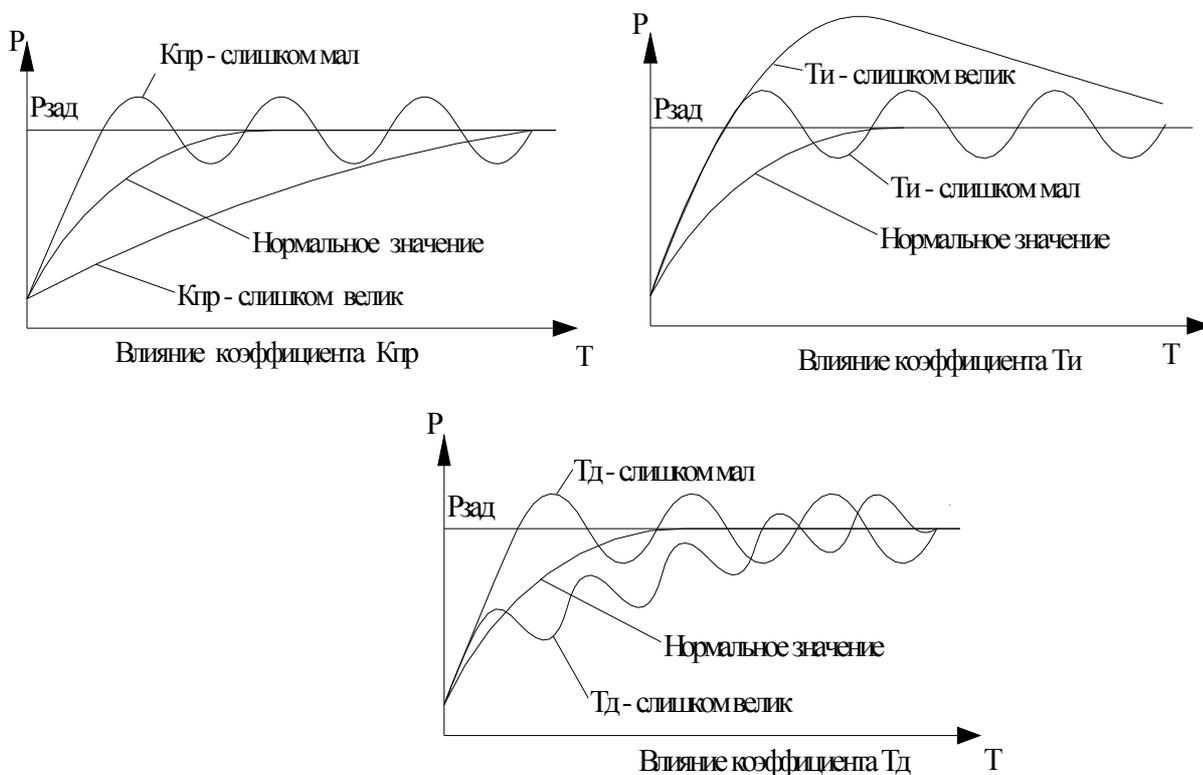
Рис.9.13. Влияние коэффициентов ПИД - регулятора на параметры переходных процессов
