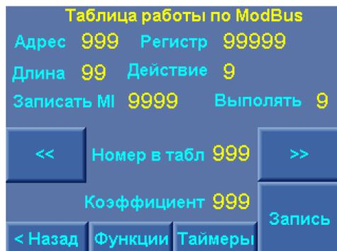
Рис. 6.1П. Меню настройки протокола ModBus
