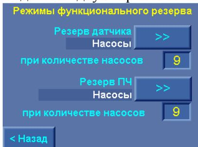
Рис. 9.25. Меню Режимы функционального резерва
