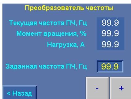
Рис. 7.15. Меню параметров преобразователя частоты
