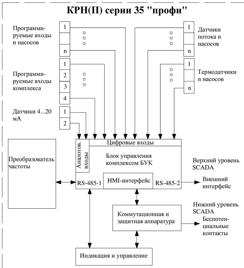
Рис. 2.1. Структура комплекса регулирования КРН(II) профи
