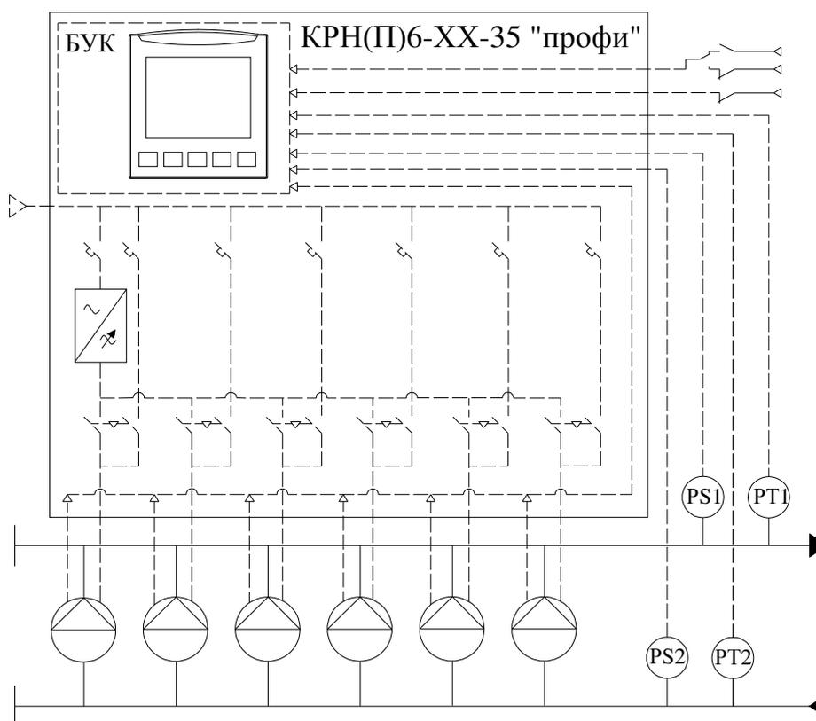
Рис.1 Структура установки пожаротушения с комплексом КРН(П)6-XX «профи»
