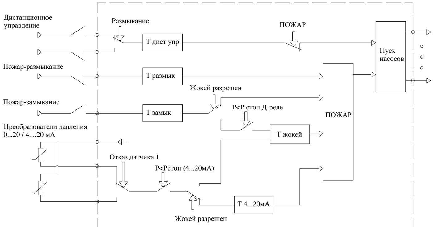
Рис. 3.1. Структура информационных каналов КРН(П) «профи»
