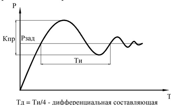
Рис. 9.12. Значения параметров ПИД-регулятора
