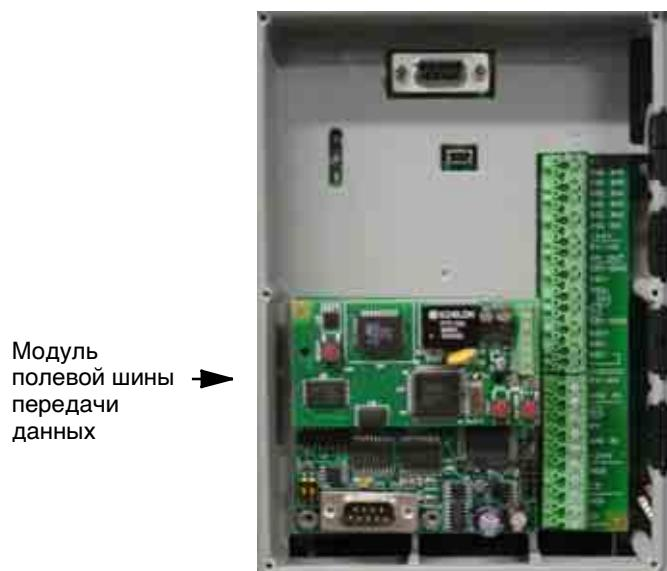
Рис. 25: PumpDrive с модулем полевой шины передачи данных, пример: шина Lon
