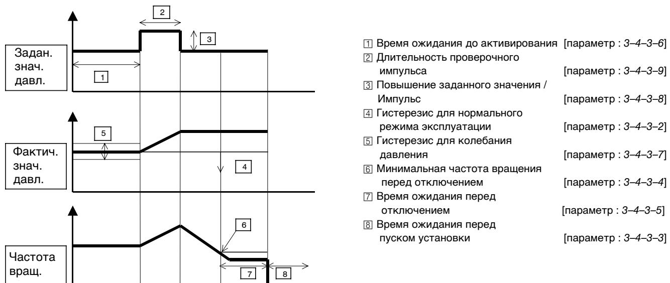
Рис. 36: Временной ход параметра для режима готовности
