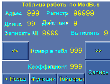
Рис. 6.1П. Меню настройки протокола ModBus
