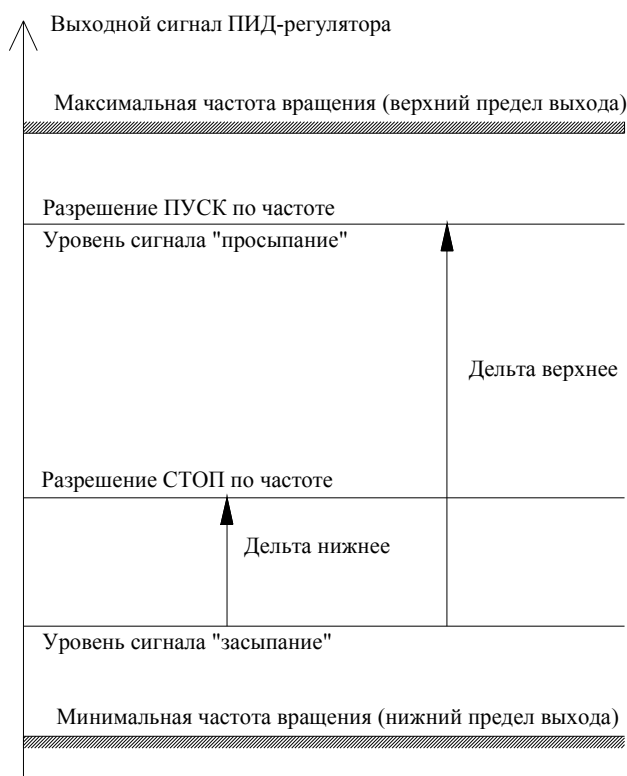
Рис. 4.3. Схема формирования команд управления по уровням сигнала ПИД-регулятора Условия формирования команд пуска и останова при активной функции «Пуск по частоте» приведены в табл. 1
