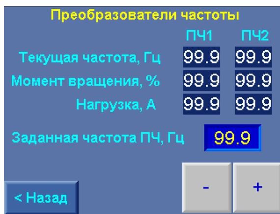
Рис. 9.4. Меню Индикации параметров ПЧ в режиме ramпы
