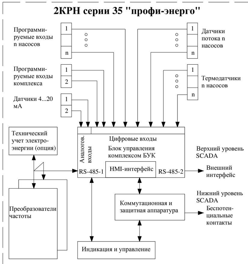
Рис.2.1. Структурная схема КРН серии 35 «профи-энерго»
