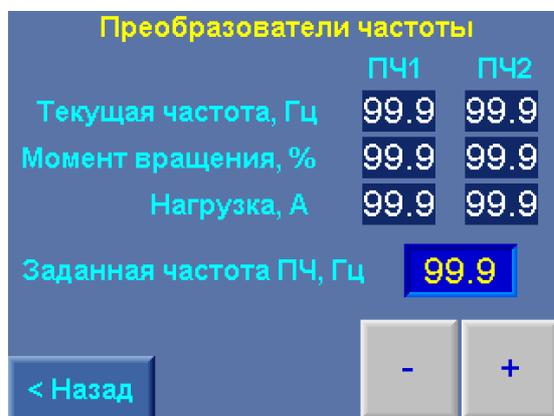
Рис. 8.16. Меню параметров преобразователя частоты
