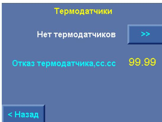
Рис. 10.11. Меню Контроль термодатчиков
