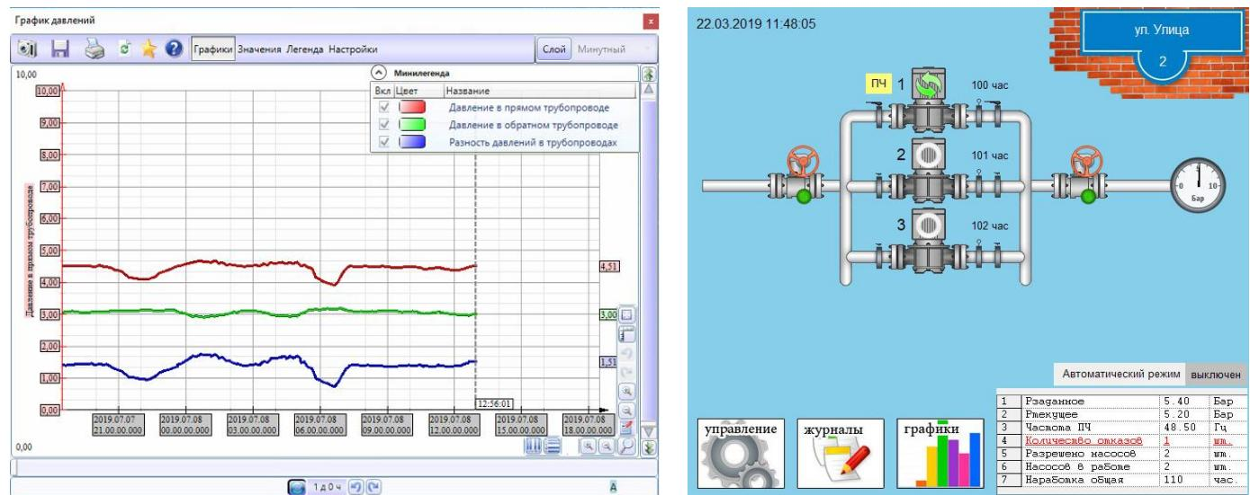
Рис. 32 Пример внешнего вида SCADA-системы объекта ЦТП
