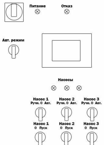
Рис. За. Панель управления КРН-А «комфорт» с HMI-экраном
