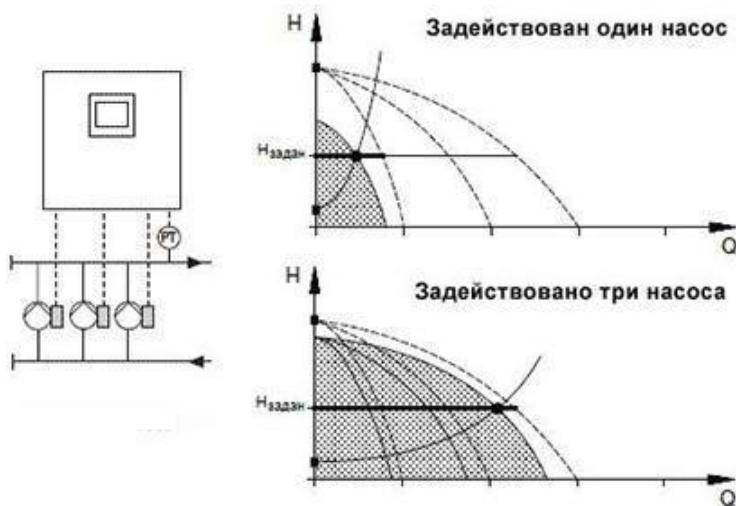
Рис. 2. Пример: Графики рабочих характеристик 3KPH-A «комфорт»
