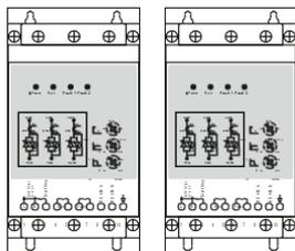
Если два или более устройства плавного пуска устанавливают горизонтально рядом друг другом, расстояние между устройствами должно быть не менее 50 мм.
