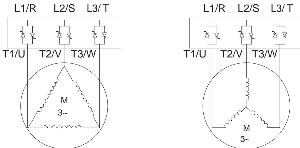
При использовании внешнего режима подключения MCD1, устройство подключают между источником питания и электродвигателем.
