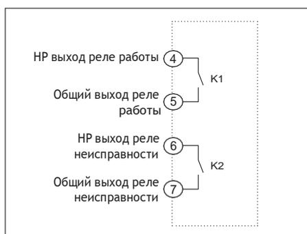
Клеммы ④, ⑤ для подключения к выходу реле работы;
